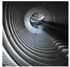
洗浄後はスパイラル搬送
