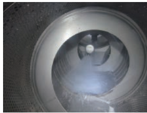
トリプルウォッシュとスパイラル搬送による洗浄ドラムで強力洗浄
