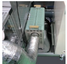
強力熱風ブローアによる乾燥ドラムにて短時間乾燥
